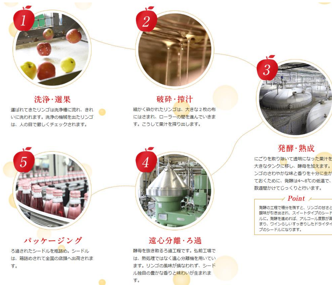
図 3-3 ニッカ工場におけるシードル製造
